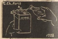
Fig. 1228-7. — Chargement de la pile. Introduction du liquide; contenance: 125 gr. environ. Observer le niveau.
